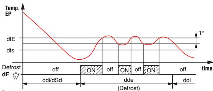
Exemple de dégivrage électrique avec control de température de l'évaporateur : le dégivrage termine lorsque le temps  $ddE$  est épuisé. Pendant le dégivrage la sortie configurée comme **dF** sera activé et désactivé comme un régulateur de température ON/OFF en fonction de réchauffage avec hystérésis de 1° afin de maintenir constante la température de dégivrage en la valeur  $dtE$  programmée.
