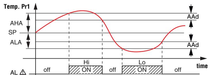
Les alarmes de température maximum et minimum, peuvent être désactivées si vous configurez les paramètres  $AHA$  et  $ALA = \text{of}$ . Les alarmes de température sont signalisées par le LED d'alarme ( $\Delta$ ) et, en configurant aussi le ronfleur.
