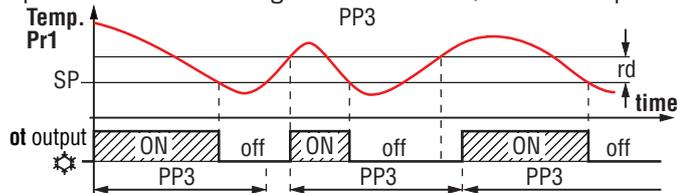
Si la protection agit, empêchant la sortie du relais pendant le temps programmé, la LED de sortie (Froid ❄️ ou Chaleur ☀️) est clignotant. Il est également possible d'éviter un retard dans le démarrage de la régulation lorsque l'alimentation du thermostat est arrivée. Le paramètre  $Pod$  est très adapté lorsqu'il y a plusieurs thermostats, de sorte que les charges ne démarrent pas au même moment et permettent au réseau électrique de démarrer plus doucement.
