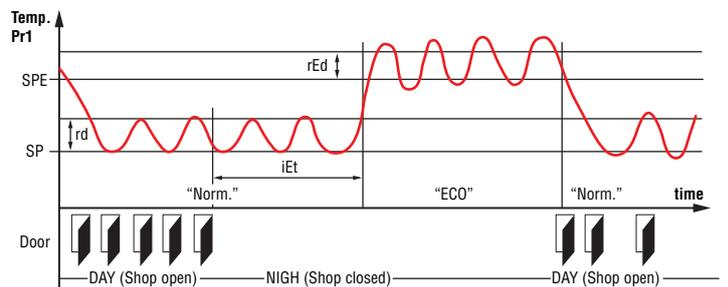
Le mode Normal / Eco peut être sélectionné manuellement:
