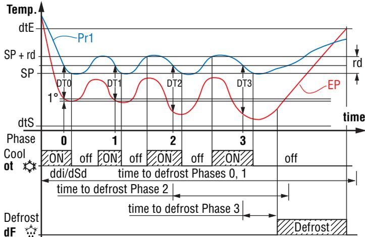
Exemple "système de dégivrage dynamique" avec une réduction  $ddd = 40\%$  et fin de dégivrage par température.
