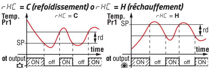
En référence au mode de fonctionnement programmé dans le paramètre  $r_{HC}$  Le régulateur considère automatiquement le différentiel avec une valeur positive pour un contrôle de refroidissement ( $r_{HC} = C$ ) o une valeur négative pour le contrôle de réchauffement ( $r_{HC} = H$ ).
