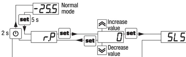
**Note:** Si le mot de passe est perdu pour accéder aux paramètres, utilisez la procédure suivante: déconnectez le courant électrique du thermostat et redémarrez-le en appuyant sur la touche **set** jusqu'à ce que le premier paramètre apparaisse. Les paramètres sont accessibles et vous pouvez modifier le paramètre  $tPP$ .
