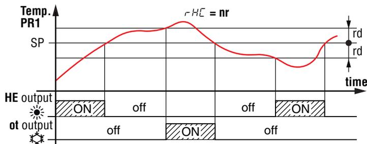
Lorsque  $r_{HC} = nr$ , la sortie configurée comme  $ot$  agit comme refroidissement (comme  $r_{HC} = C$ ) tandis que la sortie configurée comme  $HE$  agit comme réchauffement; Les deux avec le point de consigne actif ( $SP/SPE/SPH$ ). Le différentiel de régulation ( $r_d/r_{Ed}/r_{Hd}$ ) est automatiquement assumé par le régulateur pour avoir des valeurs positives pendant l'action de refroidissement et des valeurs négatives pendant l'action de réchauffement.
