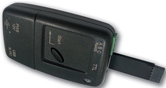
Le dispositif KEY USB est utilisé pour la programmation en série des contrôleurs qui doivent avoir les mêmes paramètres, ou pour enregistrer une copie de la programmation du contrôleur et pour pouvoir le transférer rapidement.
