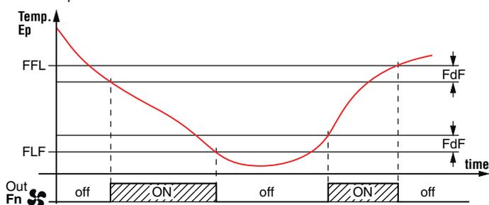
Une attention particulière doit être accordée à l'utilisation correcte des fonctions de commande du ventilateur en fonction de la température dans une application typique de refroidissement typique que le ventilateur de l'évaporateur est arrêté par changement thermique.
