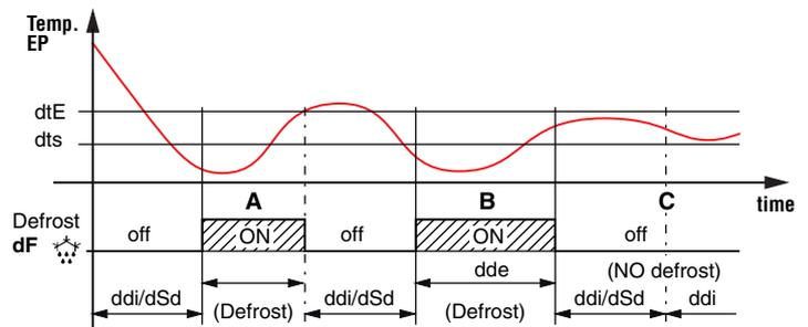
Exemple: l'instrument indiqué comme A se termine en atteignant la température "dteE"; le dégivrage B se termine à l'expiration du temps "ddeE" et n'atteint pas la température "dteE"; le dégivrage C n'est pas activé puisque la température est supérieur à "dteS"
