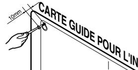
Après avoir fait coïncider l'orifice du produit avec les chevilles plastiques insérées dans le mur, fixez la partie inférieure de l'unité et serrez complètement les vis supérieures.
