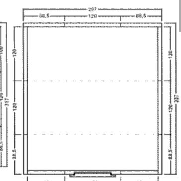
**NB:** Sur les modèles AVEC SOL, la porte est positionnable à la place de n'importe quel panneau de largeur 1200.
